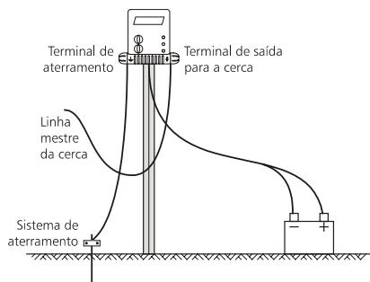
Para instalações ao ar livre, assegure-se que o energizador fique protegido do acesso dos animais. Acondicione a bateria em uma caixa ventilada, ou ao menos sobre um suporte de madeira (afastada do chão) separada do eletrificador. Cuide para que o lugar de instalação tenha um bom acesso, da existência de uma área adequada para o aterramento e de proteção suficiente contra interferência humana. Tente posicionar o energizador de maneira central em relação aos piquetes.
