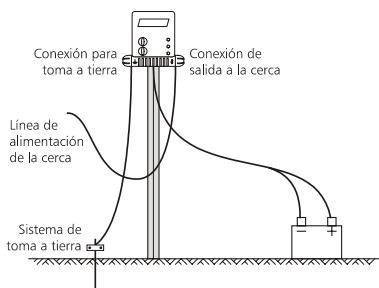
Para instalaciones exteriores asegúrese de que el energizador esté protegido de animales y de condiciones ambientales nocivas. De ser necesario, coloque el energizador en una caja para batería. Procure que el lugar de instalación sea de acceso fácil, esté cerca de una área adecuada para la toma a tierra y esté protegido contra daños causados por el hombre. Procure colocar el energizador lo más cerca posible del centro de la cerca eléctrica.
