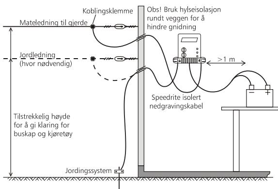
For intern installasjon, vær sikker på at gjerdeapparatet og batteriet er plassert vannrett. Monter både batteri og gjerdeapparat over gulvnivå og at disse er utilgjengelige for barn.
