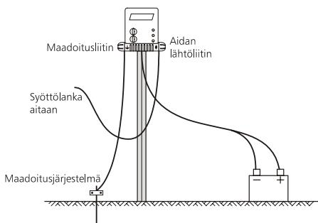
Ulos asennettaessa on varmistettava, että sähköpaimen on suojaattu eläimiltä ja säältä. Tarpeen vaatiessa sijoita sähköpaimen akun koteloon. Ota huomioon asennuspaikan pääsytie, maadoitukseen sopivan alueen läheisyys ja se, onko sähköpaimen suojaattu niin, etteivät ihmiset pääse sitä koskettamaan. Yritä sijoittaa sähköpaimen mahdollisimman lähelle sähköaidan keskiosaa.
