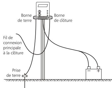
Pour des installations à l'extérieur, l'électrificateur doit être protégé contre les animaux et l'environnement. Si
