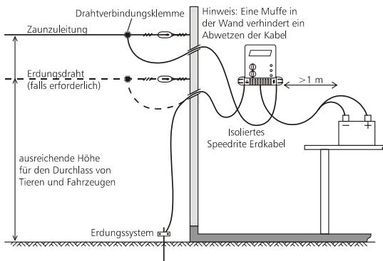
Bei einer Installation in einem Gebäude sorgen Sie dafür, dass das Elektrozaungerät und die Batterie gerade montiert werden. Montieren Sie die Geräte nicht auf dem Boden sondern höher, außerhalb der Reichweite von Kindern.
