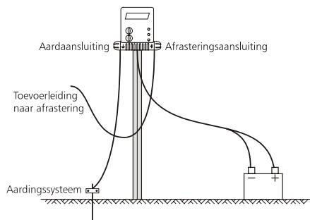
Als u het elektro-afrasteringsapparaat in de openlucht installeert, zorg er dan voor dat het tegen dieren en milieuvluchten beschermd is. Breng het elektro-afrasteringsapparaat zonodig in een accubak onder. Houd rekening met de toegankelijkheid van de plaats van opstelling, evenals het voorhandenzijn van een passend aardeoppervlak en zorg ervoor dat het elektro-afrasteringsapparaat voldoende tegen storingen door mensen is beschermd. Probeer het
