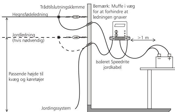
Sørg for ved indendørs installation, at spændingsgiveren og batteriet er på linje med hinanden. Monter dem begge to et stykke over jordhøjde og uden for børns rækkevidde.
