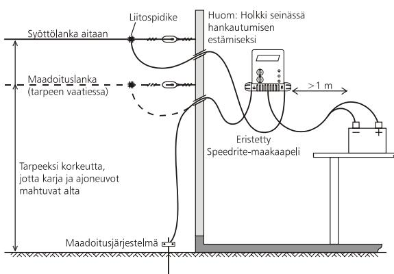
Sisätiloihin asennettaessa on varmistettava, että sähköpaimen ja akku ovat vaakatasossa. Asenna molemmat lattiataso yläpuolelle, pois lasten ulottuvilta.
