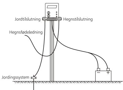
Sørg for ved udendørs installation at spændingsgiveren er beskyttet mod dyr og omgivelserne. Om nødvendigt kan spændingsgiveren bygges ind i en batterikasse. Vær opmærksom på, at der skal være god adgang til placeringsstedet, at stedet er i nærheden af en passende jordforbindelse og at spændingsgiveren er sikret mod ødelæggelse fra menneskehånd. Forsøg at placere spændingsgiveren omrent i midten af det elektriske hegnet.
