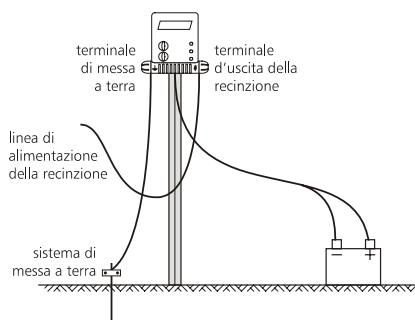
Prima di installare l'elettrificatore all'aperto, verificate che l'apparecchio sia al riparo da animali e agenti atmosferici. Se necessario, alloggiate l'elettrificatore in un apposito contenitore per batteria. Valutate la facilità di acceso al luogo e la presenza di un'area adatta alla messa a terra che sia al riparo da interferenze umane. Si consiglia di situare l'elettrificatore il più vicino possibile al centro della recinzione elettrificata.
