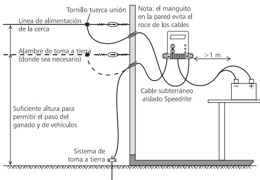
Para instalaciones interiores, asegúrese de que el energizador y la batería se monten nivelados en el plano horizontal. Monte los dos encima del nivel del suelo y fuera del alcance de los niños.
