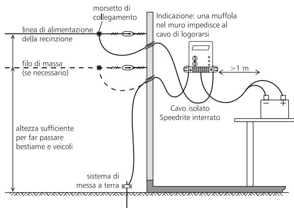
Prima di installare l'apparecchio in luoghi chiusi, verificate che elettrificatore e batteria siano a livello. Non installate l'elettrificatore e la batteria direttamente sul terreno ma ad un livello più alto, fuori dalla portata dei bambini.
