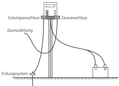
Achten Sie bei einer Installation im Freien darauf, dass das Elektrozaungerät vor Tieren und Umwelteinflüssen geschützt ist. Falls erforderlich, montieren Sie das Elektrozaungerät in einem Batteriekasten. Achten Sie auf eine gute Zugänglichkeit des Installationsorts, das Vorhandensein einer angemessenen Fläche zur Erdung, und auf einen ausreichenden Schutz des Elektrozaungeräts vor Störungen durch Menschen. Versuchen Sie, das Elektrozaungerät möglichst in der Mitte des Elektrozauns zu montieren.
