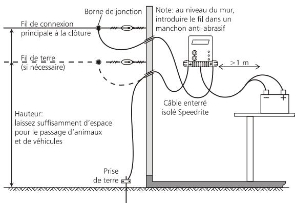
Pour des installations à l'intérieur, positionnez l'électrificateur et la batterie au même niveau. Montez-les au-dessus du niveau de sol, hors de portée d'enfants.
