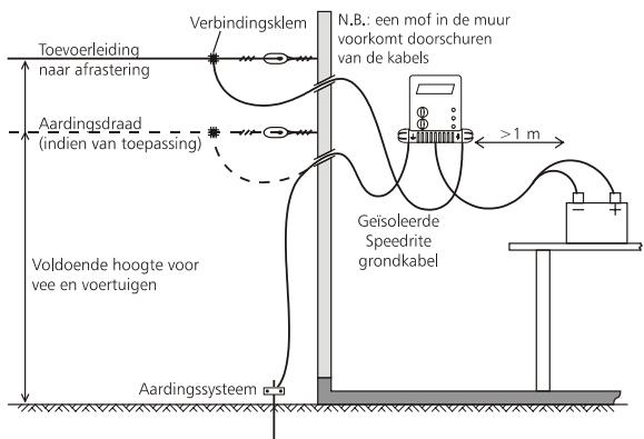
Bij het installeren in een gebouw dient u ervoor te zorgen dat het elektro-afrasteringsapparaat en de accu recht staan. Montere beide hoger dan de grond, zodat ze buiten het bereik van kinderen zijn.
